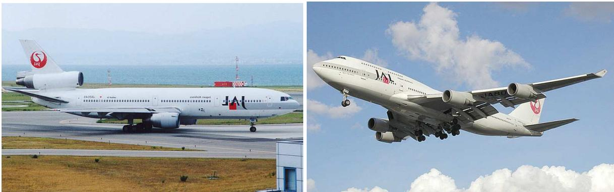
(Bei den beiden Maschinen der *Japan-Airline* handelte es sich um eine DC-10-40 [li] und eine Boeing 747-400)
